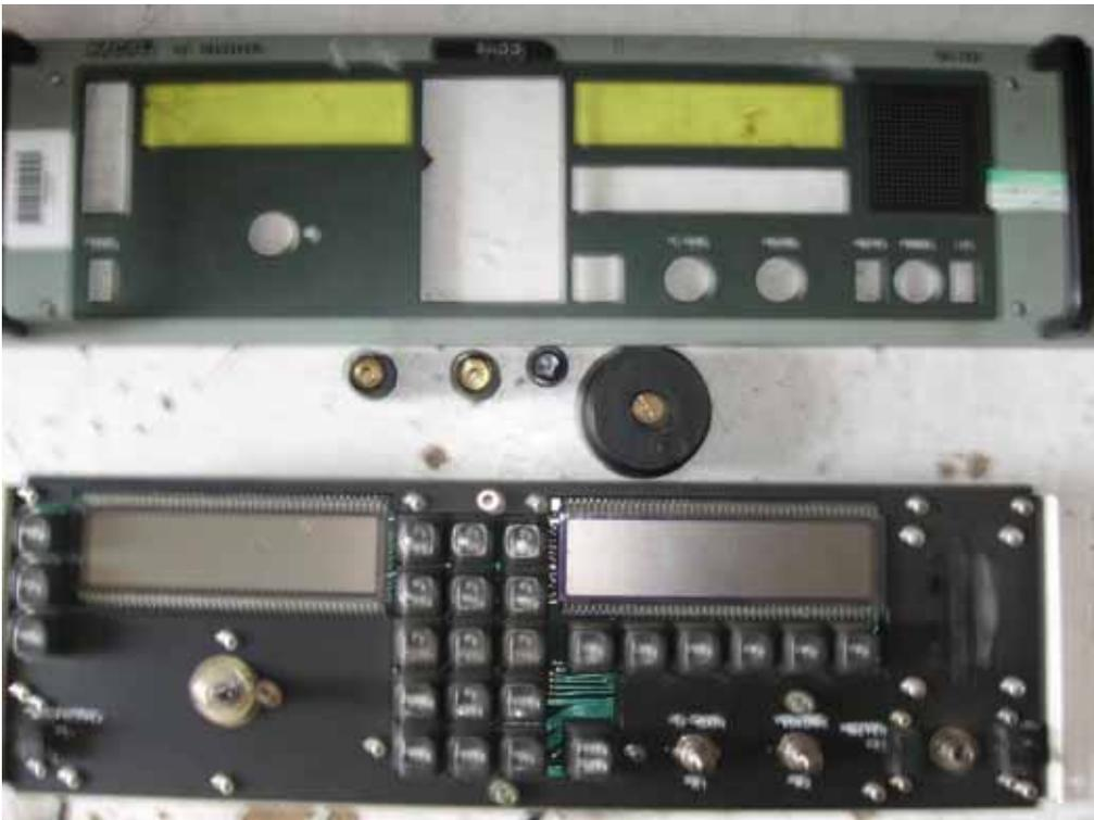
Adesso bisogna rimuovere i vecchi display aiutandosi con dei cacciaviti a punta fine. Attenzione che se volete conservare integri i display bisogna fare molta attenzione nel rimuoverli in quanto sono molto fragili e potrebbero spezzarsi.
