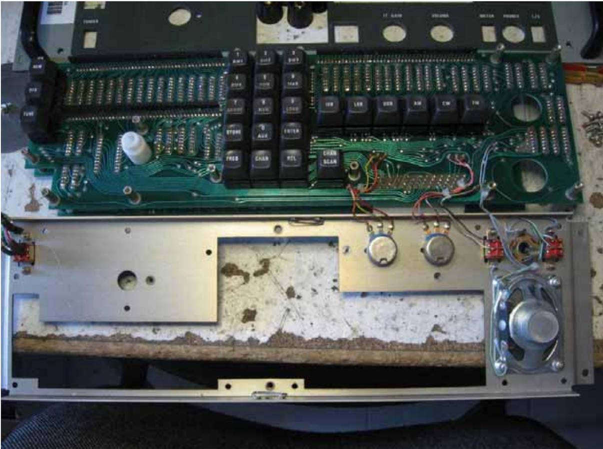
Piegate leggermente verso l'interno l'angolo superiore destro del connettore display di sinistra come in figura, questa operazione serve per permettere il passaggio della piattina del nuovo display.
