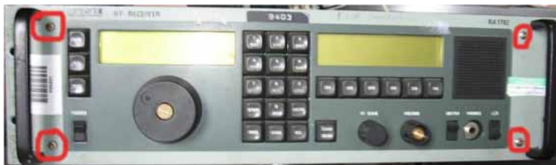
Smontate le tre manopole sul frontale e rimuovete la vite che si scopre sotto la manopola della sintonia, come ben visibile nella foto seguente.
