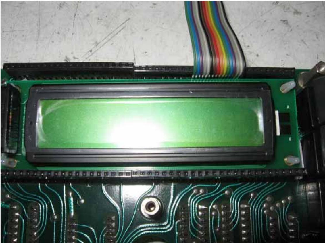
Mettete ora il circuito con la parte display rivolta verso il basso e toglie le viti per rimuovere il circuito stampato superiore in modo da poter sistemare il cavo come mostrato nelle due figure seguenti
