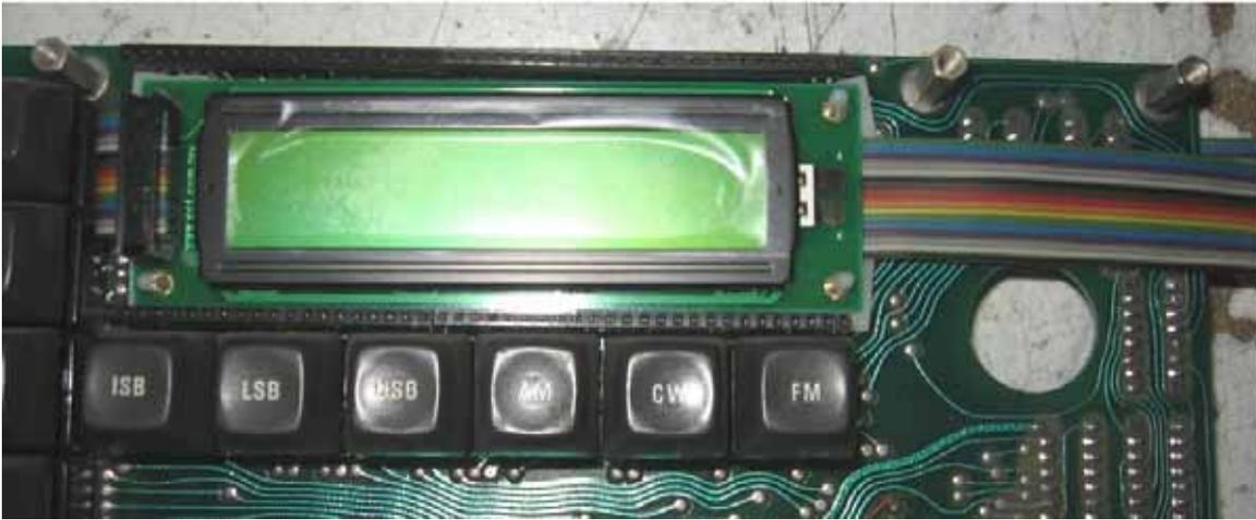
Una volta sistemato anche il secondo display potrete rimettere il controltaio, non dimenticate di inserire prima di avvitarlo l'alloggiamento per il perno della manopola della sintonia tolto in precedenza.
