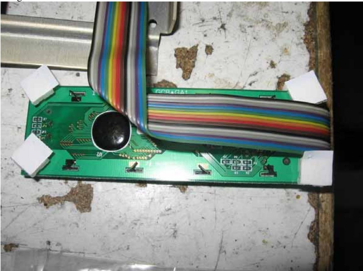
Ed inserite il display all'interno dello zoccolo del vecchio display come mostrato in figura
